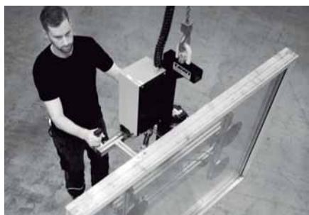
Los polipastos y los útiles de agarre le permiten levantar cargas con una precisión y exactitud óptimas. Son equipos estables y fáciles de usar.
