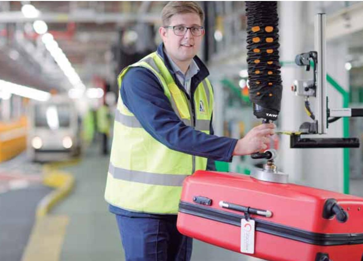
La manipulación de equipaje pesado es fácil y sin esfuerzo con nuestro elevador por vacío de alta frecuencia.
