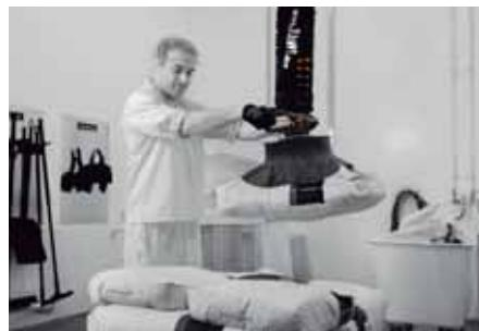
Los elevadores por vacío ofrecen una manipulación sostenible, segura y eficaz de la mayoría de los tipos de cargas hasta 270 kg.
